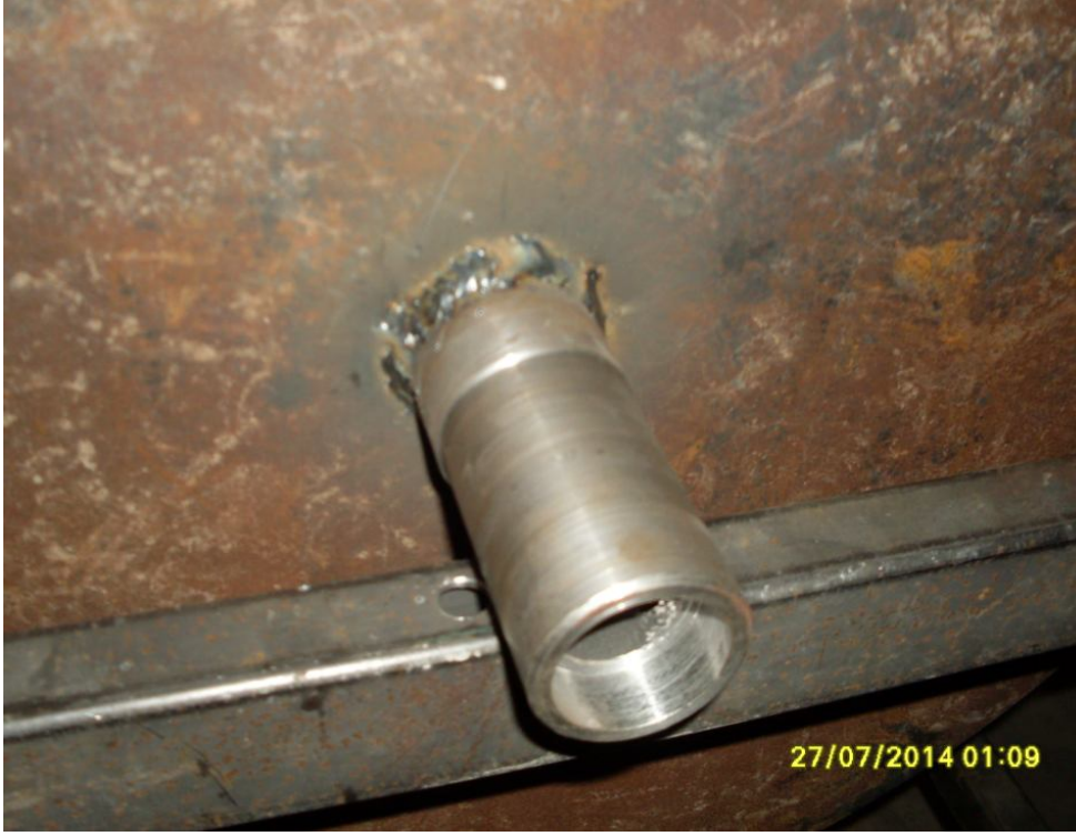
Resim 3.8 Büyük mil kaynatılmış şekli
