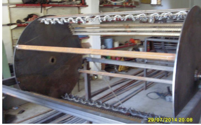
Resim 3.11 Bıçak, fırça ve ara bağlantıların montajı
