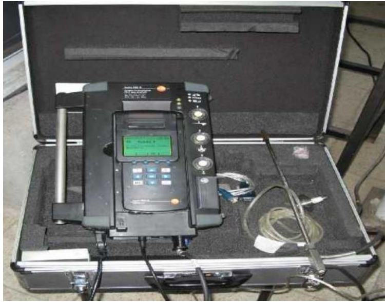
Resim 4.7 Testo 350-s marka egzoz emisyon cihazı.
