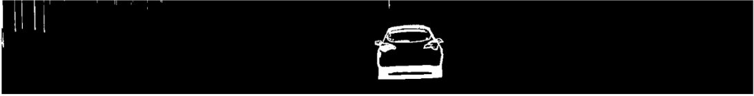
Şekil 4.3 Geometrik dönüşüm ve ardışık çerçeve farkı ve eşikleme işlemleri sonrası elde edilen hareketli nesne silueti.
