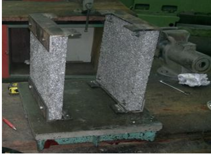
Resim 4.2 Gözenekli alüminyum malzemeden yapılmış ayak.
