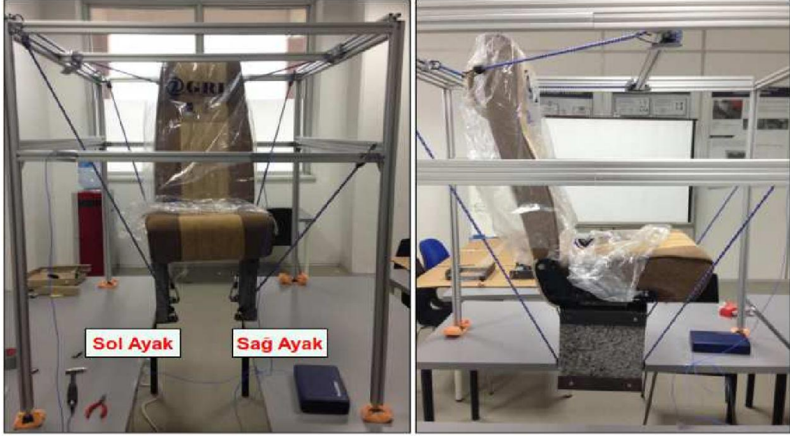
Resim 3.12 M1 ve M2 ayağı monte edilmiş koltuk.
