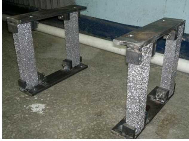
Resim 4.3 Alüminyum gözenekli malzemedan imal edilen ayak.
