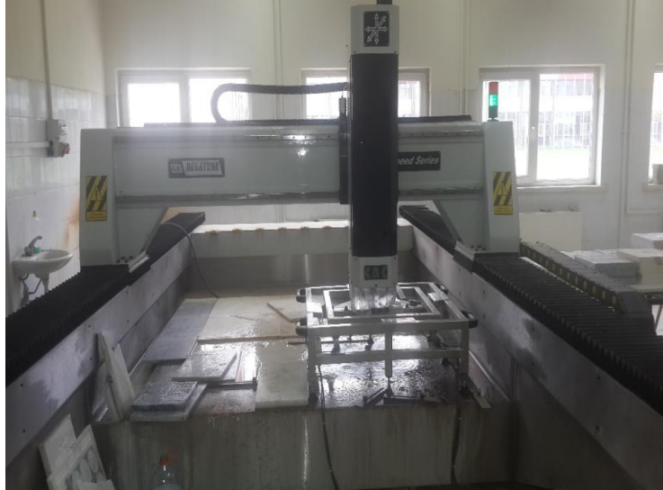
Şekil 3.9 CNC Makinesinde güç ve yük ölçer cihazı ile ölçüm ünitesi görünümü.
