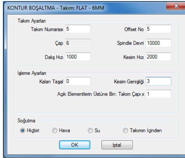
Şekil 3.22 Dış hatlar işleme türünün takım ayarları.
