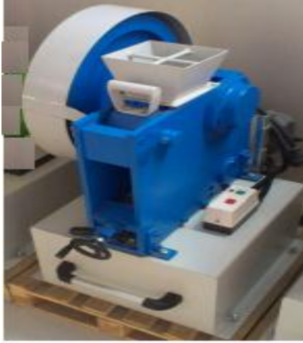
Şekil 3.3. Çalışmada kullanılan laboratuvar tipi çeneli kırıcı (Merttest marka LB 100 model).
