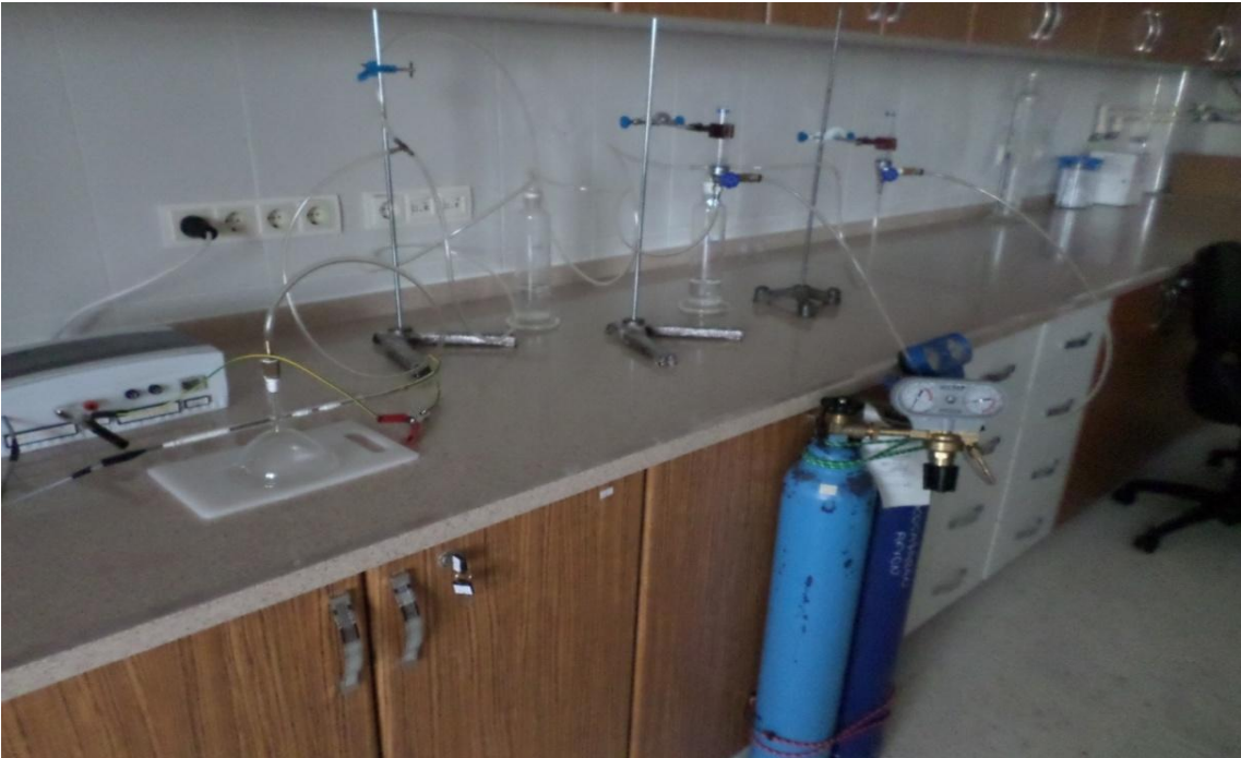
Resim 3.2 Atmosferik basınç plazma sistemi düzeneği ve kullanılan gazlar.
