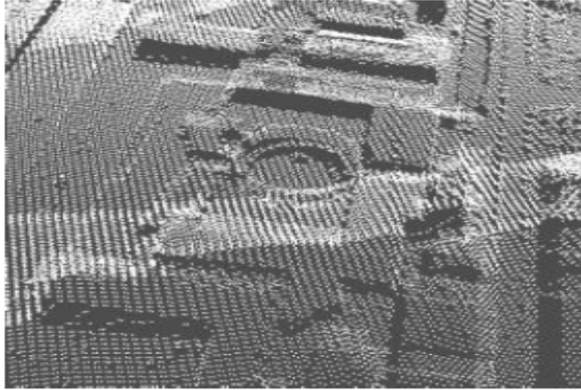
řekil 2.7 Eřit daęılmamıř LiDAR nokta bulutu (Liu 2008).
