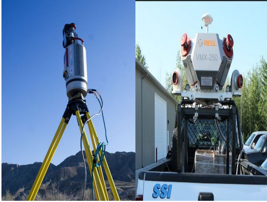
Şekil 1.2 Yersel ve Mobil LiDAR Sistemleri.
