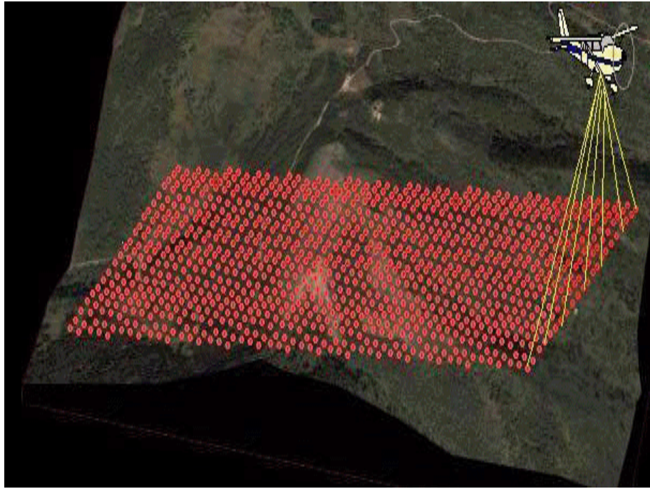
Şekil 2.3 Hava LiDAR sisteminde lazerin iz düşümü (İnt.Kyn.3).
