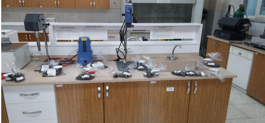
Resim 3.13 Tane boyut analizi yapılmaya hazır paketlenmiş kömür numuneleri.
