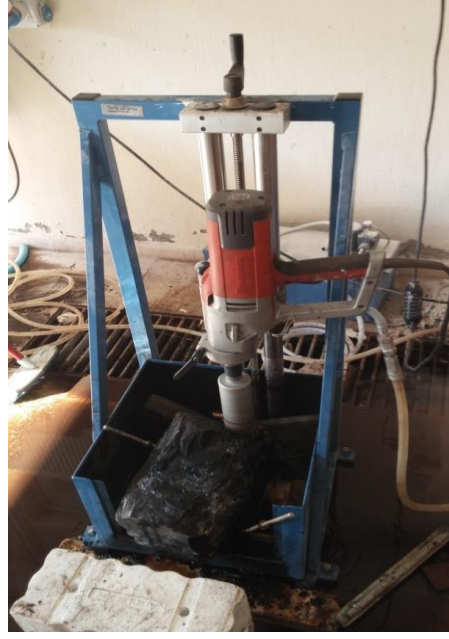
Resim 3.6 Nokta yükleme deneyleri için gereken numunelerin karot makinesiyle alınışı.
