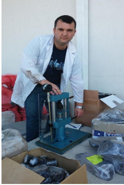
Resim 3.8 Nokta yükleme dayanım ölçü aleti ile dayanım deneylerinin yapılışı.
