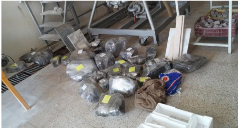
Resim 3.3 Doğal nemlerini muhafaza etmeleri için esnek filme sarılan blok numuneler.
