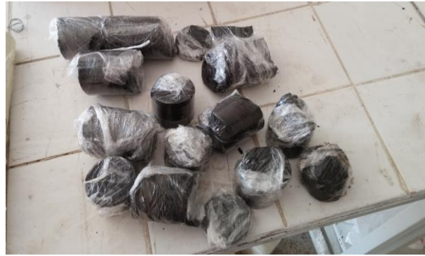
Resim 3.7 Nokta yükleme deneyi için esnek film ile muhafaza edilen kömür numuneleri.
