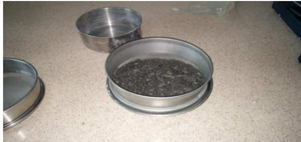
Resim 3.11 Farklı tane boyutunda numune elde etmede kullanılan elekler.
