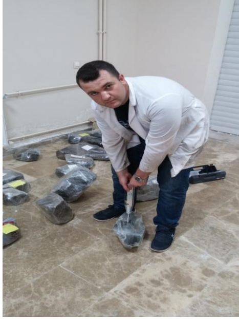
Resim 3.5 Schmidt sertlik ölçüm deneylerinin yapılışından bir kesit.
