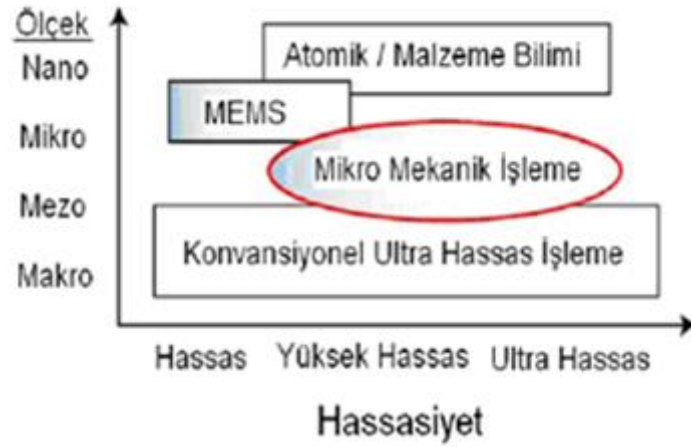
Şekil 2.2 Mikro mekanik işlemenin diğer yöntemlerle kıyaslanması (Chae et al. 2006).
