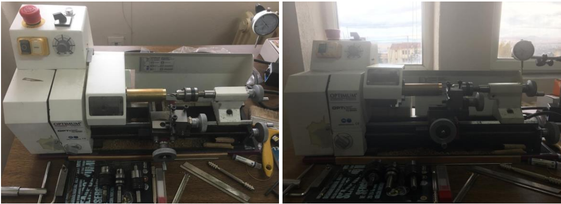
Resim 2.1 Konvansiyonel torna tezgahının ölçeklendirilerek mikro parça işleme seviyesine indirilmiş mini torna tezgahı.
