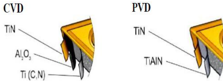
Resim 2.5 İki farklı kesici takım ve kaplama özellikleri (Gürbüz et al. 2011).
