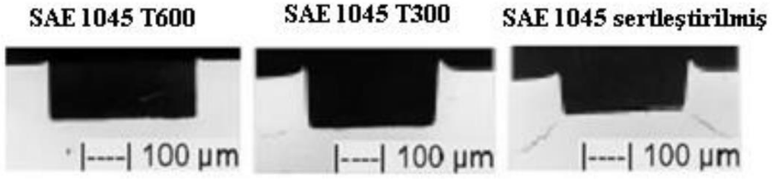
Şekil 2. 18 Farklı iş malzemelerinin çapak oluşumuna etkisi (Weule et al. 2001).
