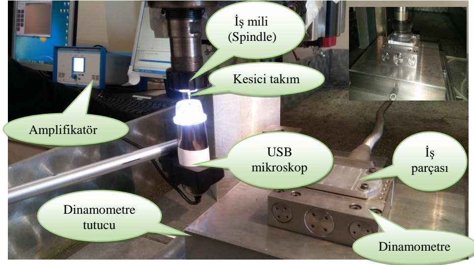
Resim 3. 1 Mikro kesme işleminin gerçekleştirildiği deney düzeneği.
