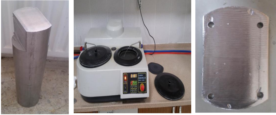
Resim 3. 2 İş malzemesinin deney şartlarına geometrik olarak hazırlanması.
