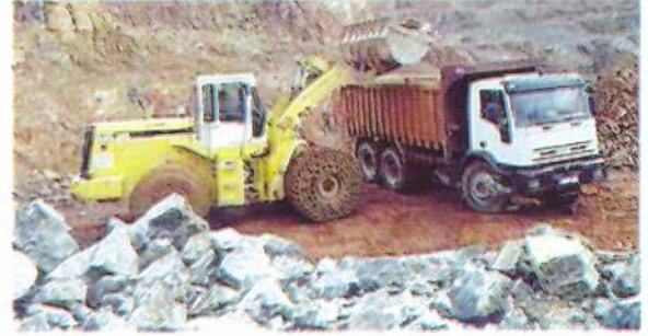
Şekil 2. Mermer yatağı üzerindeki örtü tabakasının yükleyici+kamyon yöntemiyle kaldırılması (Dekapaj).
