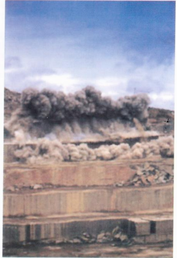
Şekil 6. Bir granit ocağında patlatma sonucu oluşan geçici toz bulutu.
