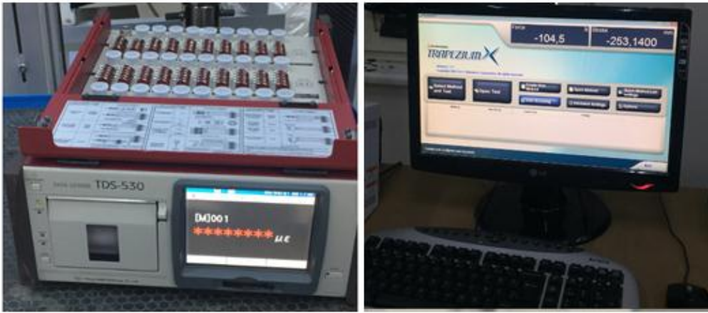
Resim 3.29 Çekme testinde kullanılan a) Data logger b) bilgisayar ara yüz yazılımı.
