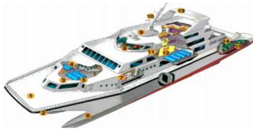
Resim 1.7 Hızlı feribotta sandviç yapının kullanıldığı kısımlar (Yiğit 2010).
