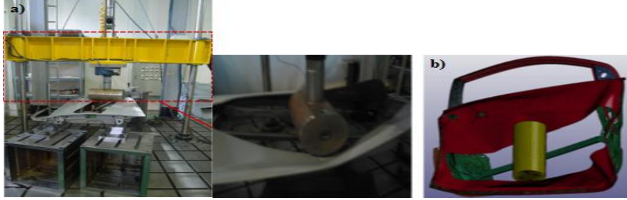
Resim 2.4 a) Serbest düşme testi b) ANSYS modellenme gösterimi (Yoon vd. 2016).
