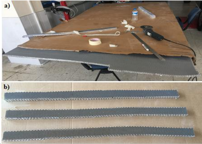
Resim 3.42 Alüminyum bal petek yapısının a) Al tabaka b) İstenilen ebatlarda kesim işlemi ( 800 \times 45 \times 1.8 \text{ mm} ).
