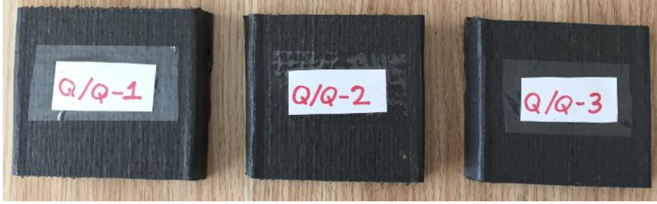
Resim 3.39 C_4^8 oryantasyonlu numunenin standart ölçülere göre kesilmesi.
