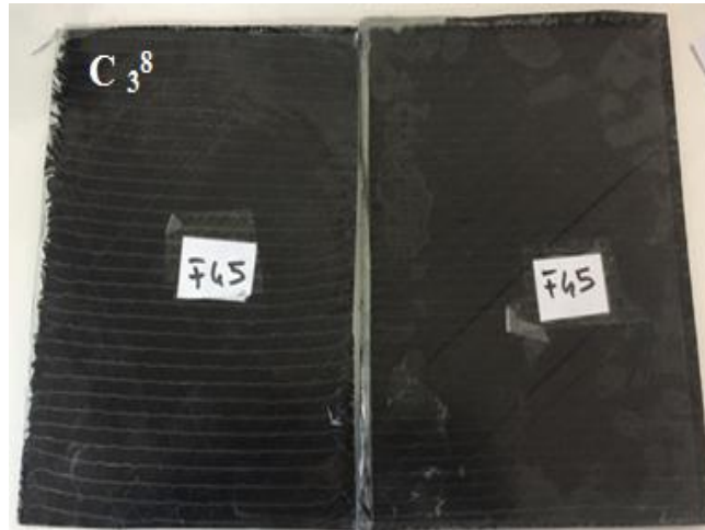
Resim 3.18 C_3^8 oryantasyon açılı karbon fiber malzeme plakası.
