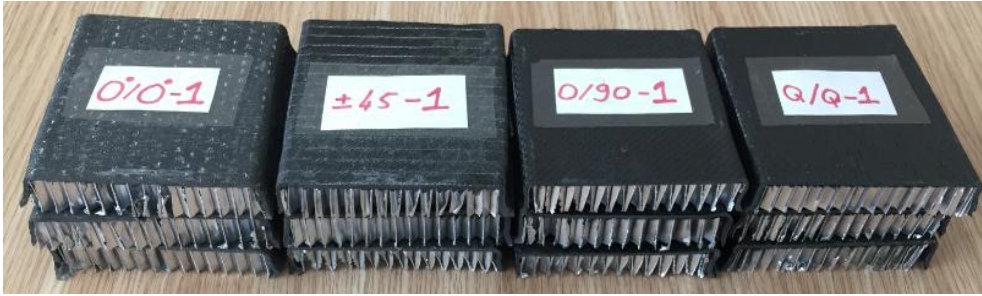
Resim 3.40 C_1^8 , C_2^8 , C_3^8 ve C_4^8 oryantasyon açılı numunelerin darbe test standart ölçülerine göre hazırlanmış hali.
