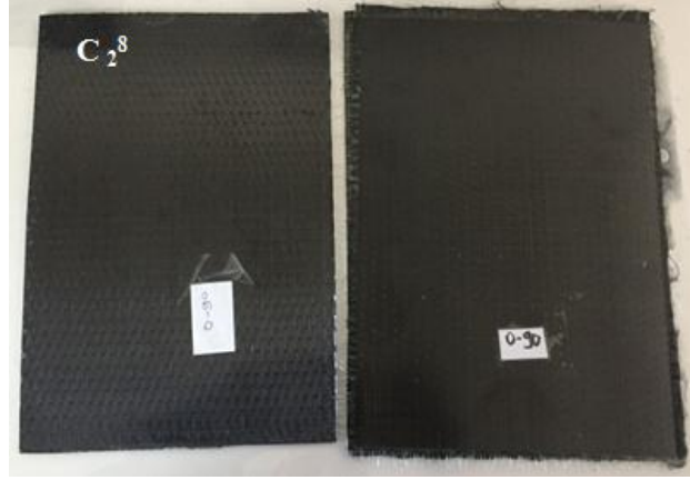
Resim 3.15 C_2^8 oryantasyon açılı karbon fiber malzeme plakası.
