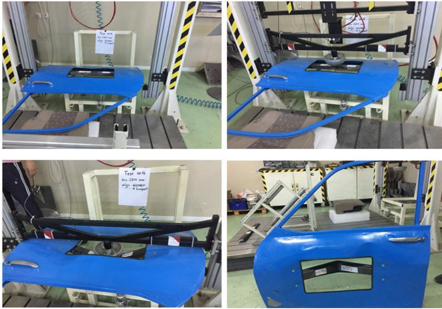
Resim 4.8 Nomex petek yapılı tabakalı karbon fiber kirişe serbest düşme (2.5 m).
