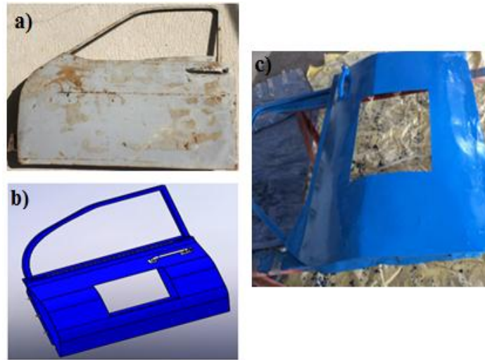
Resim 3.47 Testlerde kullanılacak otomobil kapısının a) ilk hali b) Solidworks çizimi c) işlemden geçirilmiş hali.
