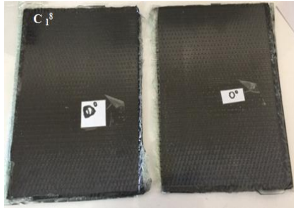
Resim 3.12 C_1^8 oryantasyon açılı karbon fiber malzeme plakası.
