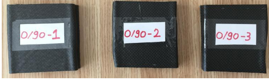
Resim 3.35 C_2^8 Oryantasyonlu numunenin standart ölçülere göre kesilmesi.
