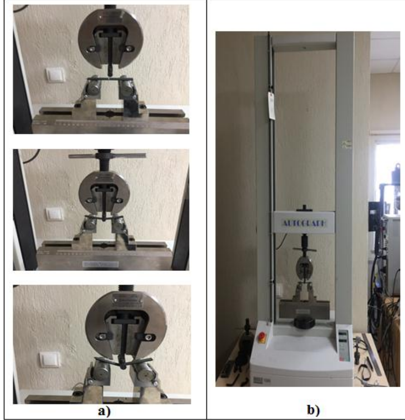
Resim 3.24 Hazırlanan test numunelerin a) Üç nokta eğme testi b) AUTOGRAPH cihazı.
