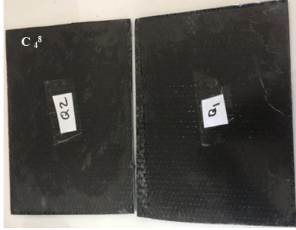
Resim 3.21 C_4^8 oryantasyon açılı karbon fiber malzeme plaka.
