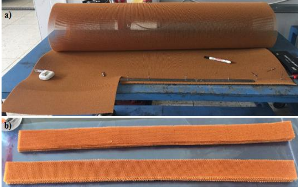
Resim 3.44 Nomex bal petek yapısının a) Nomex tabaka b) istenilen ebatlarda kesim iřlemi (800 x 45 x 0.3 mm).
