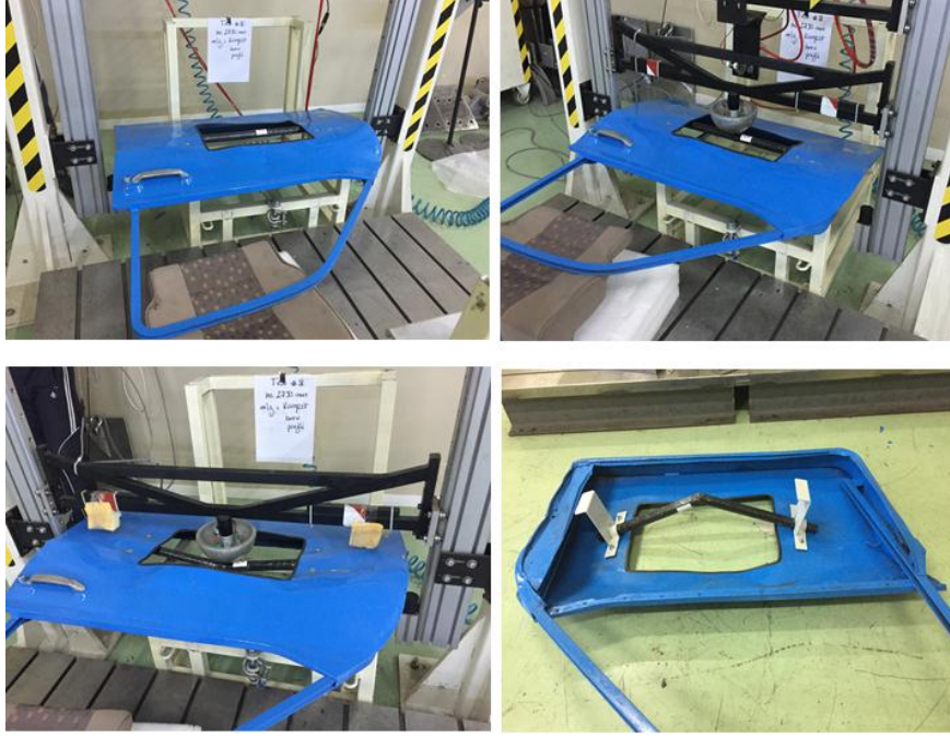
Resim 4.12 O profil tabakalı karbon fiber kiriş serbest düşme (2.75 m).
