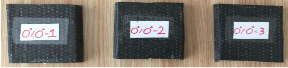
Resim 3.33 C_1^8 oryantasyonlu numunenin standart ölçülere göre kesilmesi.
