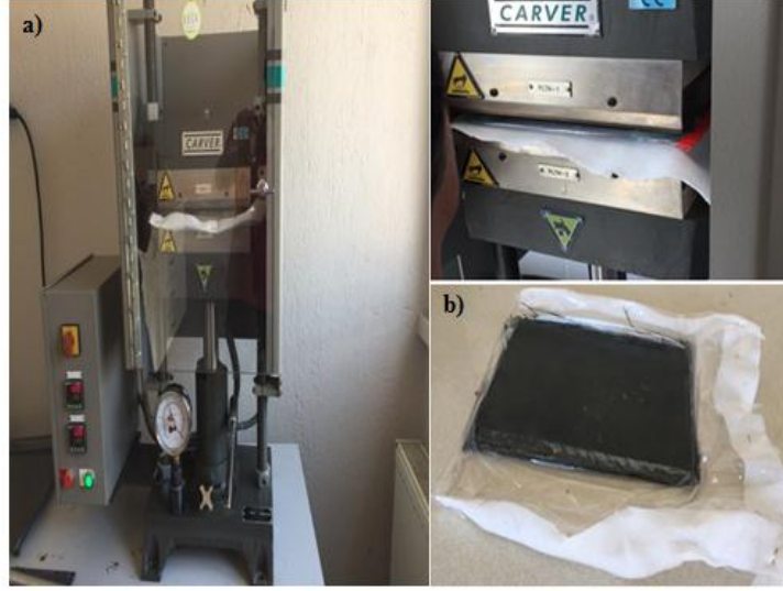
Resim 3.10 Numune parça üretimi a) Ayarlanabilir sıcak pres makinesi b) Hazırlanan numune plaka.
