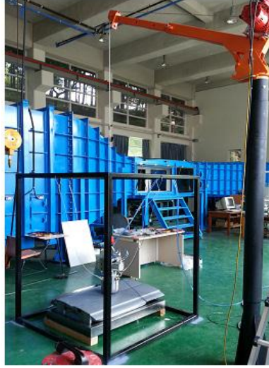
Resim 2.3 Geliştirilmiş ideal serbest ağırlık düşürme test cihazı (Kim ve Kang 2014).
