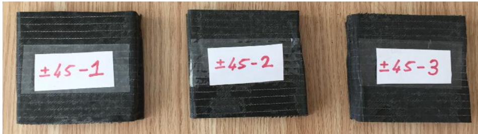
Resim 3.37 C_3^8 oryantasyonlu numunenin standart ölçülere göre kesilmesi.
