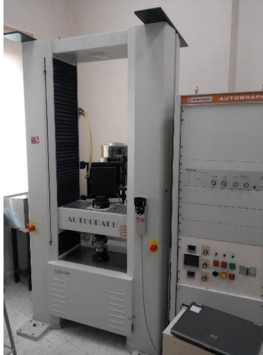
Resim 3.2 Basma dayanımı testlerinin yapıldığı cihazın görüntüsü.
