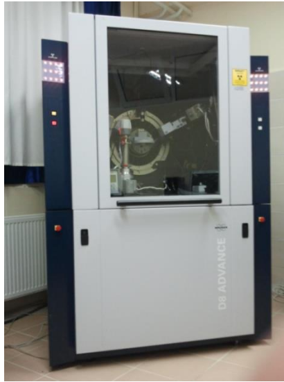
Şekil 6.3 Bruker D8 advance model X-ışını difraktometre cihazı.
