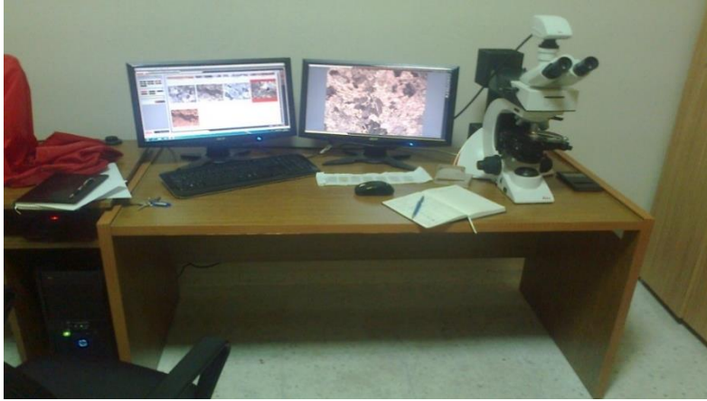
Şekil 6.4 Leica marka Dm 2500P model polarizan mikroskop.
