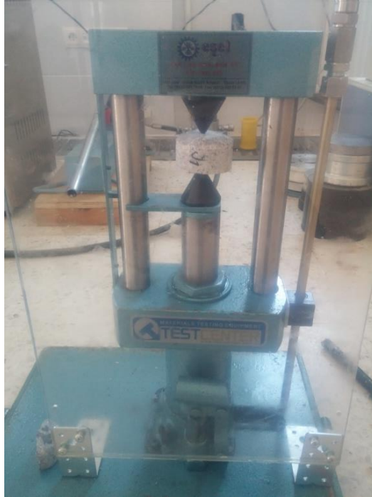
Şekil 6.7 Nokta yükleme deneyi yapılışı.
