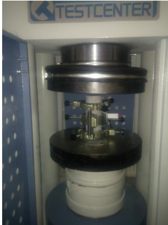
Şekil 6.10 Tek eksenli basınç mukavemeti testinin yapılışı.
