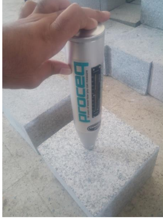
Şekil 6.6 Schmidt çekici ile yapılan ölçümler.
