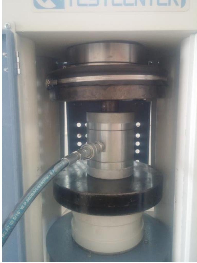
Şekil 6.11 Üç eksenli basınç dayanımı deneyi.
