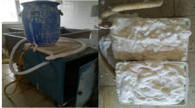
Resim 3.10 Çalışmada kullanılan köpük makinesi (solda) ve üretilen köpük (sağda) verilmiştir.
