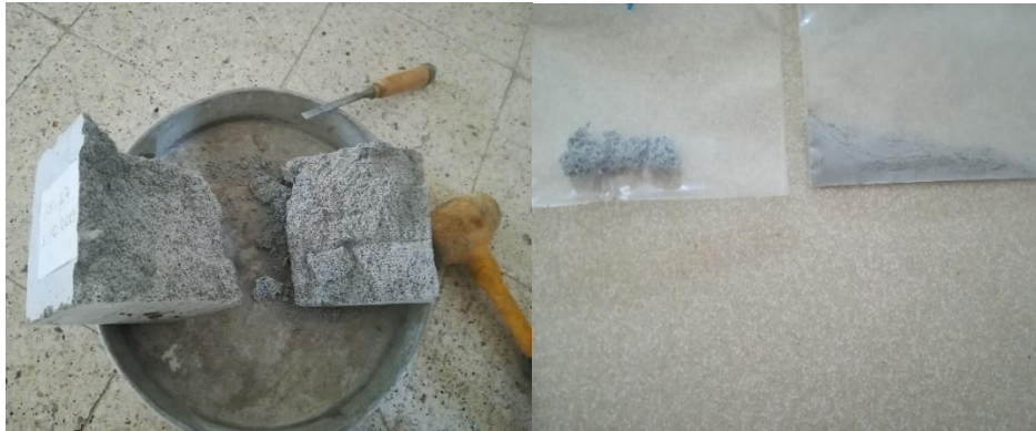
Resim 3.18 Mikroyapı inceleme için numuneden parça alım işlemi.
