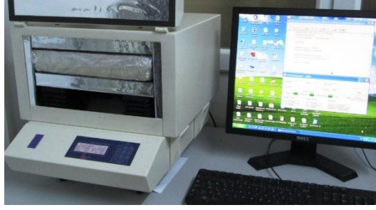
Resim 3.14 Köpük beton ısı iletkenlik değerlerinin belirlenmesi deneyi.
