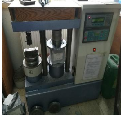
Resim 3.17 Küp numunelere uygulanan basınç mukavemeti deneyi.
