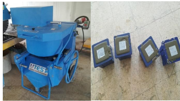
Resim 3.11 Çalışmada kullanılan mikser (solda) ve kalıplanmış köpük beton numuneleri (sağda) verilmiştir.
