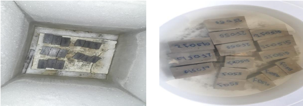
Şekil 3.4 Dondurucu dolapta ve normal hava şartlarında su bulunan kaptaki bekletilen örnekler.
