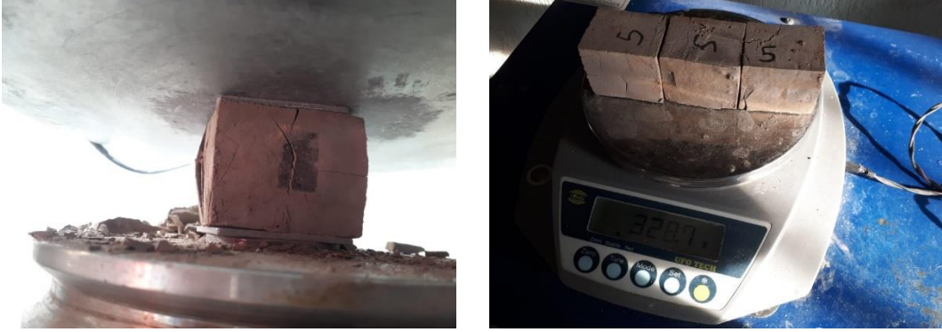
Şekil 3.5 Yüksek sıcaklığa maruz kalmış bir numunenin basınç dayanım testi.
