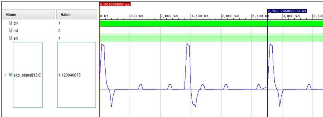
Şekil 4.52 Üçüncü derece AV Blok sinyaline ait Vivado Simülasyon sonuçları.
