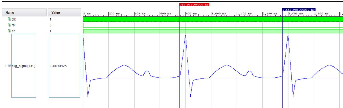
Şekil 4.25 Birinci derece AV Blok sinyaline ait Vivado Simülasyon sonuçları.
