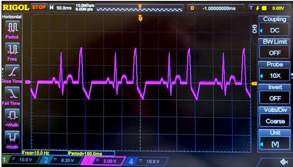
Şekil 4.44 PVC sinyaline ait osiloskop sonucu.
