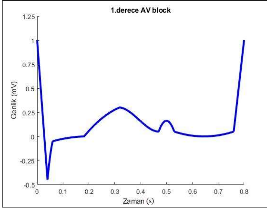
Şekil 4.24 75 vuru/dakika kalp hızına sahip Matlab'ta modellenen Birinci derece AV Blok sinyali.
