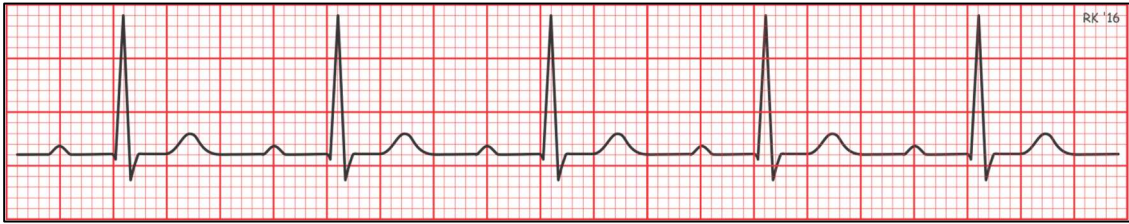
Şekil 3.18 Kalp hızı 75 vuru/dk (bpm) olan Birinci derece AV Blok sinyali (İnt. Kyn. 5).
