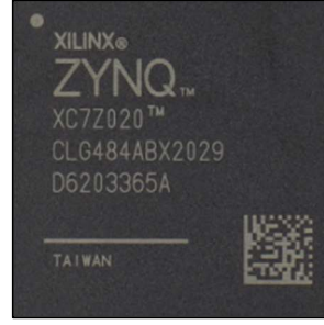
Resim 3.1 Alinx AX7020 FPGA Geliştirme Kartında bulunan XC7Z020 yongası (İnt. Kyn. 3).
