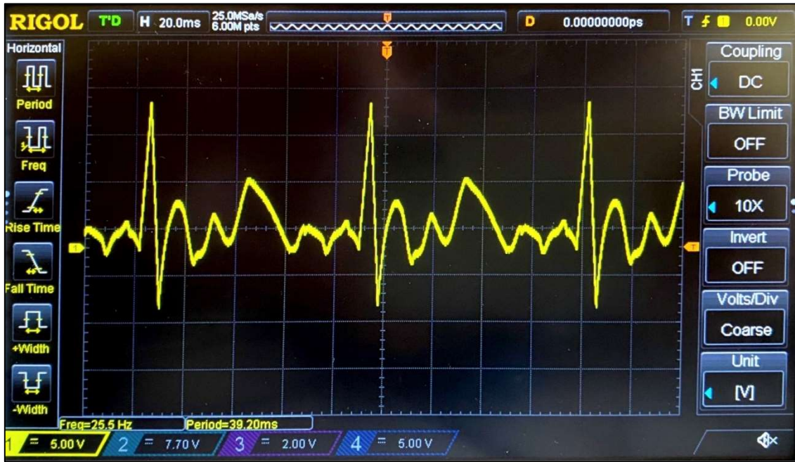
Şekil 4.47 Atrial Fibrilasyon sinyaline ait osiloskop sonucu.
