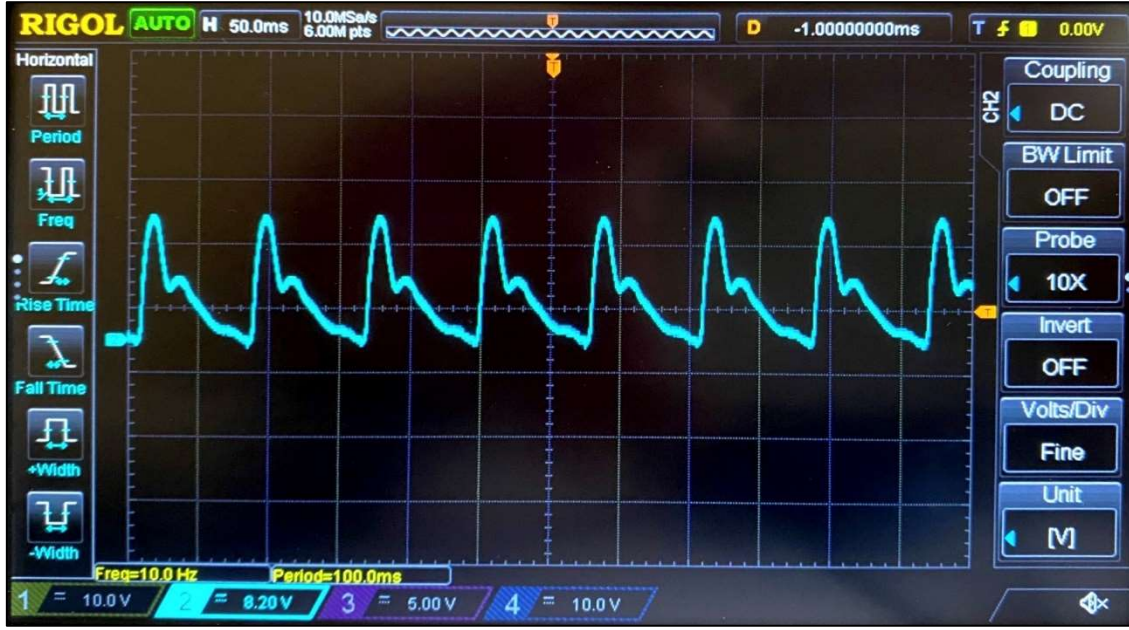
Şekil 4.32 NIBP sinyaline ait osiloskop sonucu.
