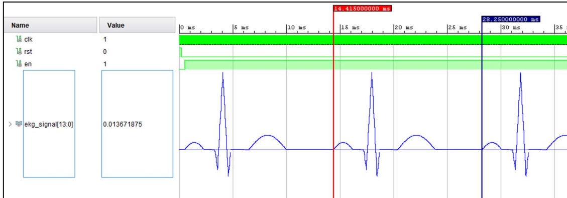
Şekil 4.4 NSR sinyaline ait Vivado Simülasyon sonuçları.
