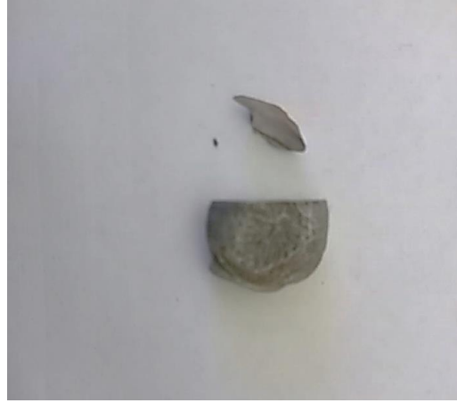
Resim 3.6 Bakır potada oluşturulan master alaşım ergime sonrası.
