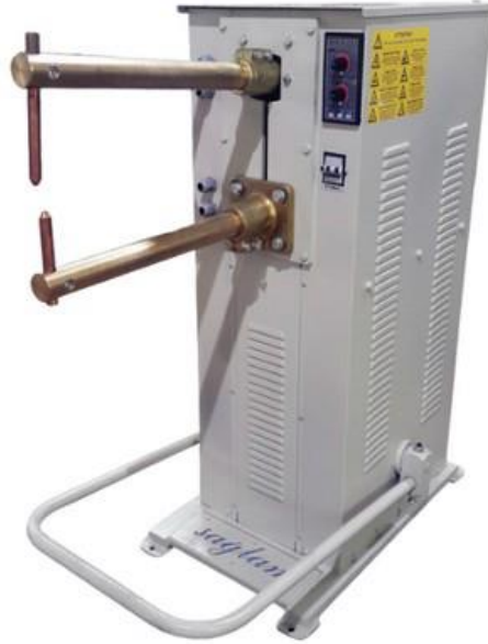
Resim 3.16 Sert lehimlemede kullanılan elektrik direnç nokta güç kaynağı.
