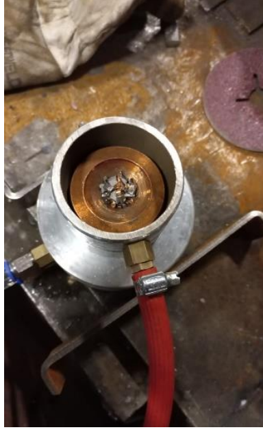
Resim 3.5 Bakır potada oluşturulan master alaşım ergime öncesi.
