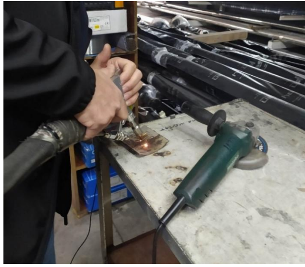
Resim 3.14 1500 W'lık DNCLazer fiber lazer kaynak makinası ile kaynaklama
