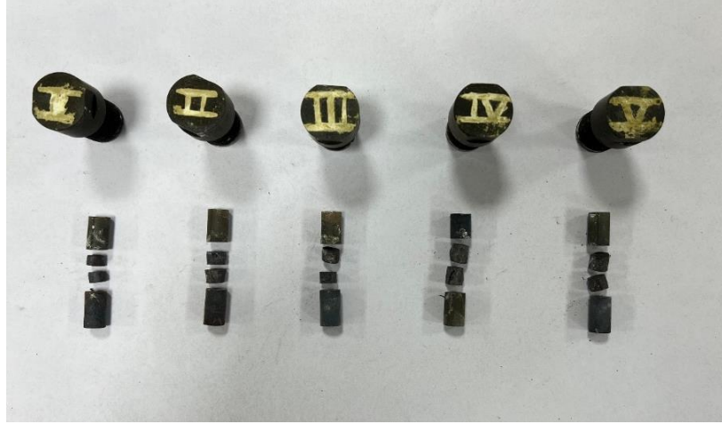
Resim 4.4 Ar gazı kullanılarak yapılan ısıtıl işlem sonrası kalıplardan çıkartılan difüzyon kaynak numunelerinin ayrılmış hali.
