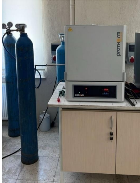
Resim 3.13 Afyon Kocatepe Üniversitesi'ndeki ısıtıl işlem fırını.
