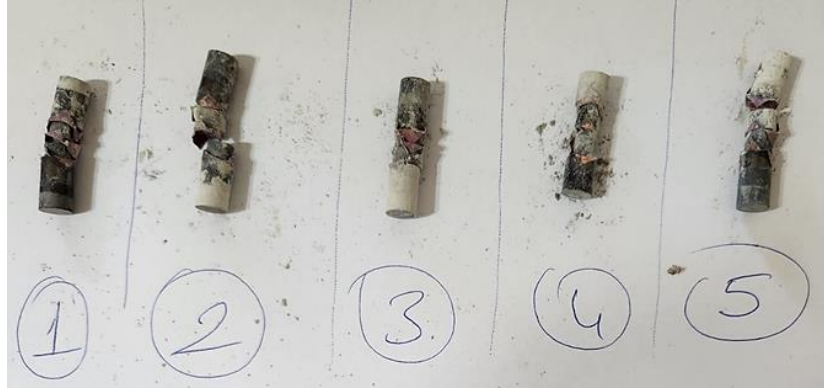
Resim 4.1 SiC kullanılarak yapılan ısıl işlem sonrası kalıplardan çıkartılan difüzyon kaynak numuneleri.
