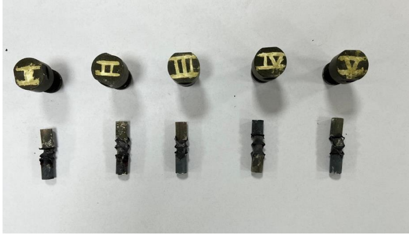
Resim 4.3 Ar gazı kullanılarak yapılan ısıtıl işlem sonrası kalıplardan çıkartılan difüzyon kaynak numuneleri.
