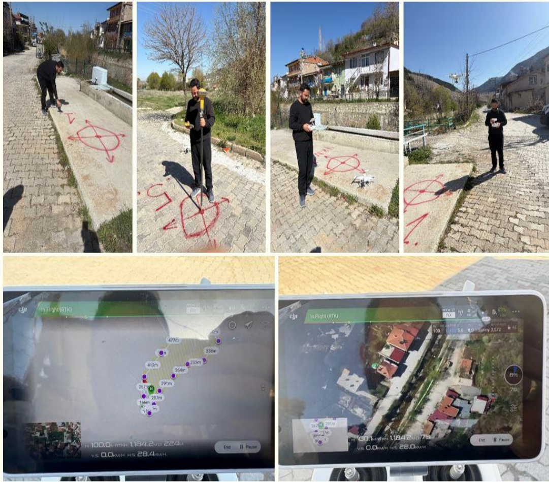
Şekil 4.4 Fotogrametri yer kontrol noktaları tesisi ve İHA ile SYM üretim aşaması
