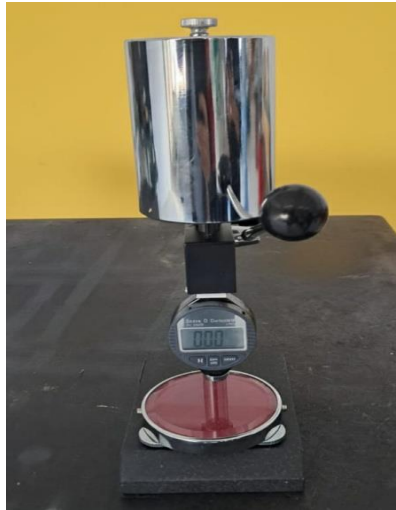
Resim 3.6 Numune sertlikleri ölçümünde kullanılan Shore D ölçüm standı
