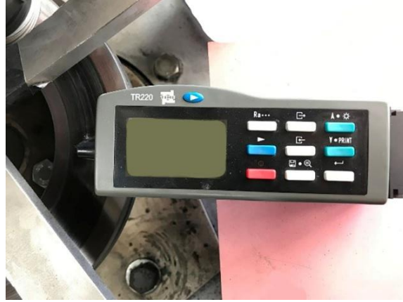
Resim 3.7 Yüzey pürüzlülük ölçüm cihazı.
