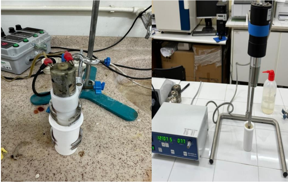
Resim 3.3 Sırasıyla mekanik karıştırıcı ve ultrasonik sonikatör
