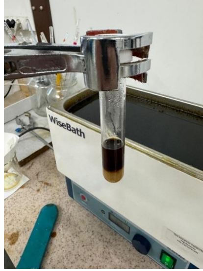
Resim 3.2 POTFAMA sentezinden yağ banyosunda polimerizasyon aşaması
