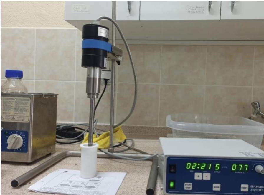
Resim 3. 3. Karışımın ultrasonik banyoda karıştırılması.
