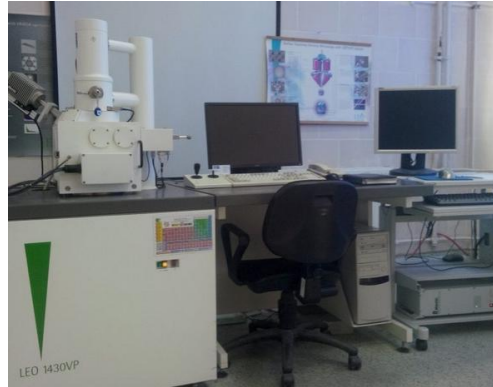
Resim 3.6 Mikroyapı analizi için kullanılan elektron mikroskobu görüntüsü
