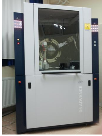
Resim 3.5 XRD analizinde kullanılan Bruker Advance D8 cihazının görüntüsü
