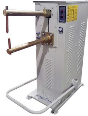
Resim 3.2 Birleştirme işleminde kullanılan direnç nokta kaynak makinası
