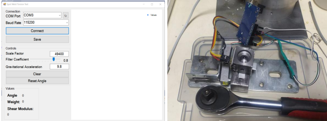
Resim 3.8 Burma testi cihazı ve yazılım arayüzü
