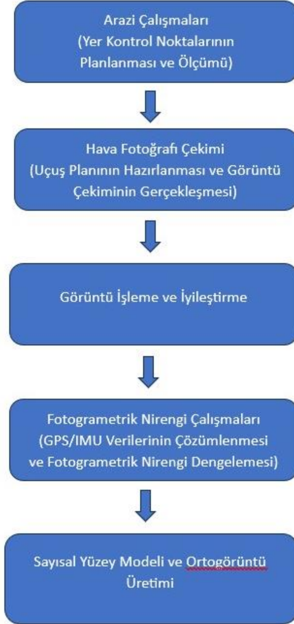
Şekil 3.6 Sayısal Fotogrametri İşlem Adımları (Şencan, 2023).
