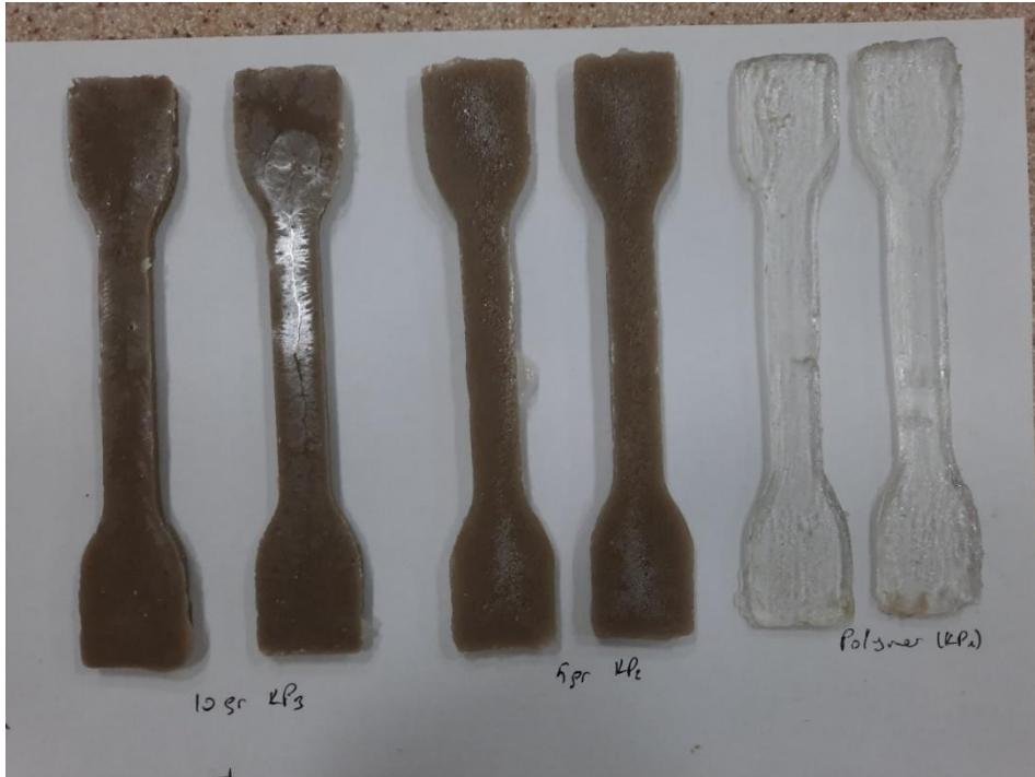
Resim 3.6 Çekme testi için kaşık kalıplara döküm.
