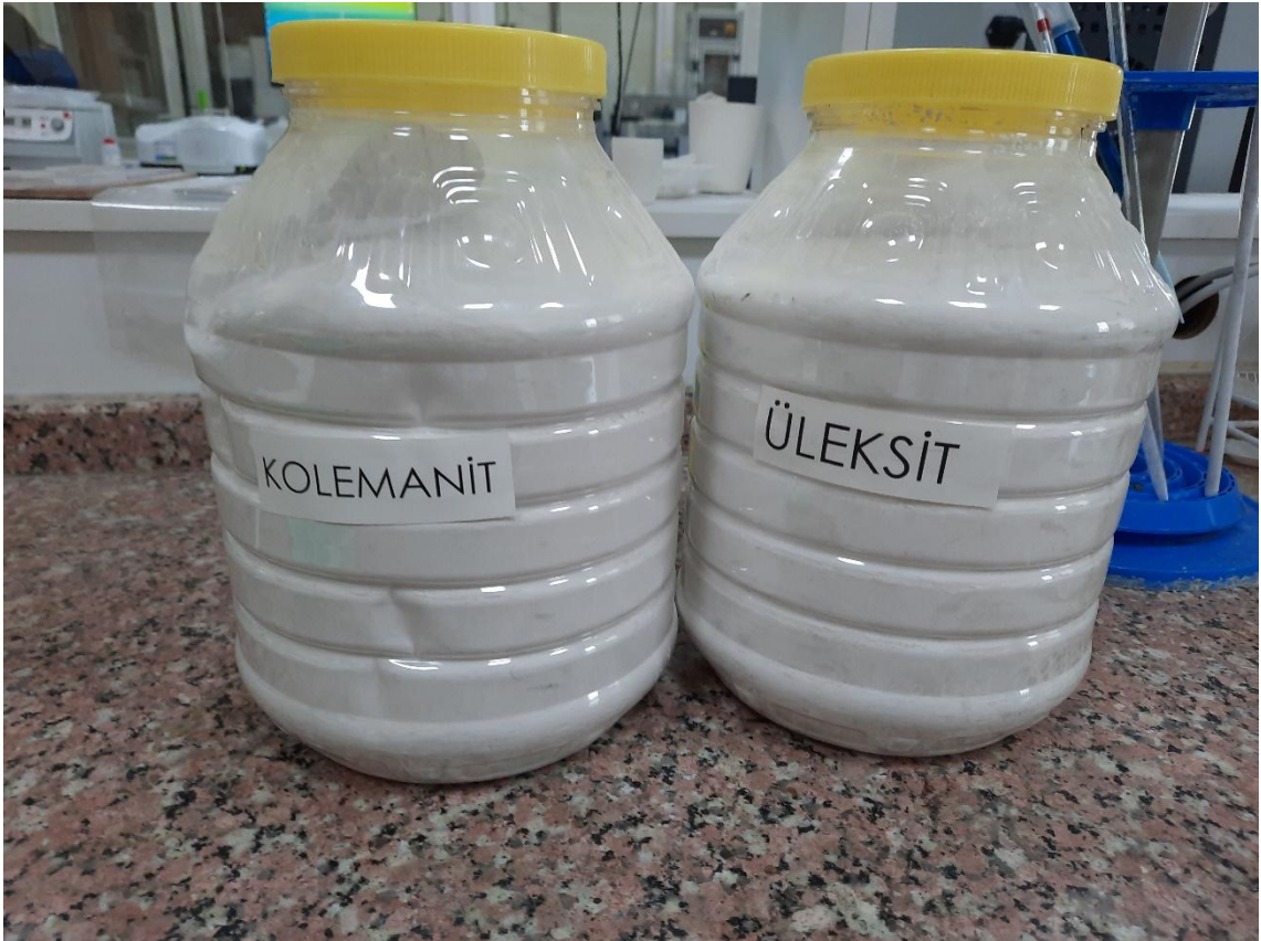
Resim 3.2 Çalışmalarda kullanılan kolemanit ve üleksit tozları.
