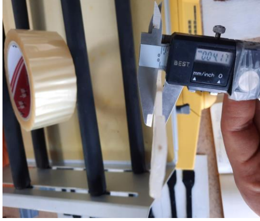
Resim 3.6. Best model kumpas yardımı ile en boy kalınlıkların ölçümü.
