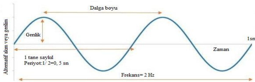
Şekil 2. 3 Sinüsoidal dalganın dalga boyu, periyot ve frekans tanımı.
