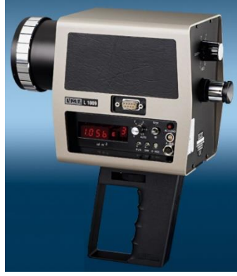
Resim 2. 4 Luminans metre (Parıltı ölçer) görüntüsü (İnt. Kyn.22).
