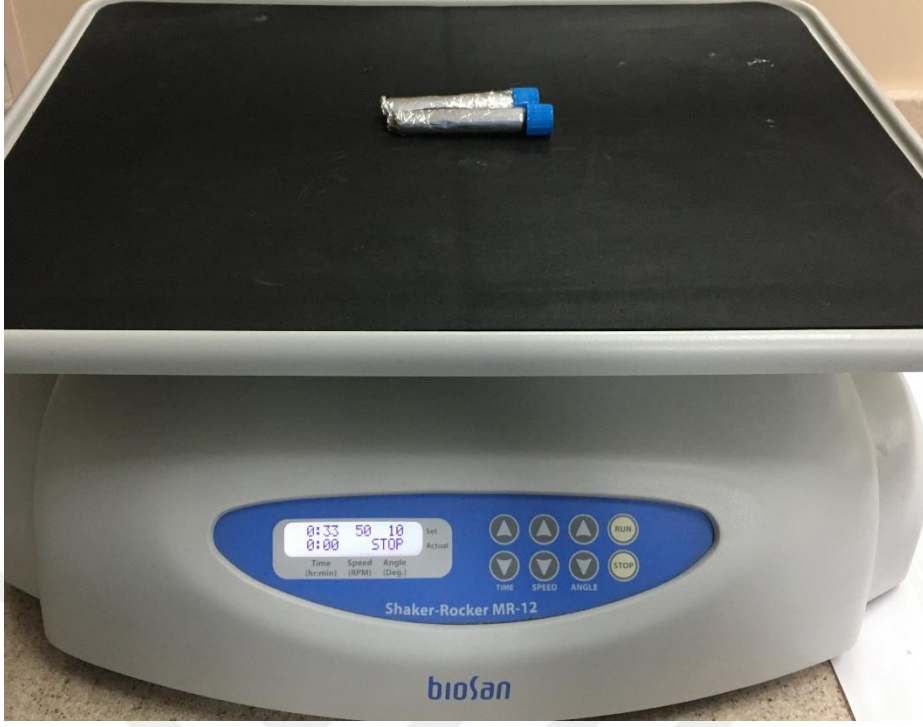
Resim 2.3: Pıhtılaşmanın önlenmesi için tüplerin karıştırıcıya yerleştirilmesi
