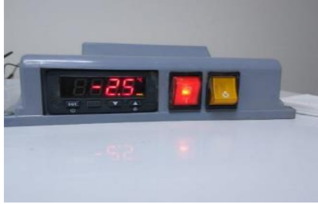
Şekil 2.4: Donma koşullarının oluşturulması için -2.5\text{ }^{\circ}\text{C} 'ye ayarlanmış inkübatör.
