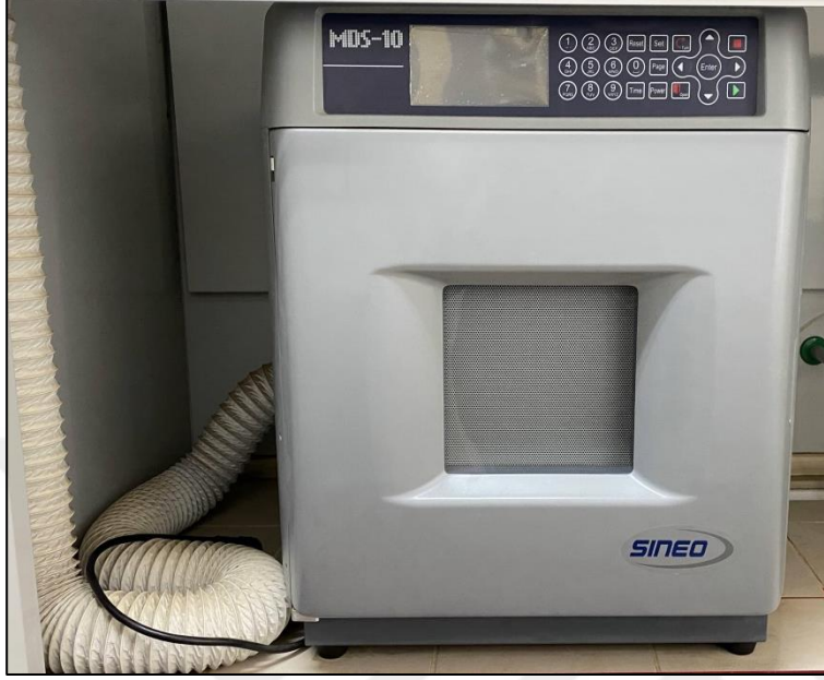
Resim 2.2. Numune yakma fırını (SINEO, MDS 10)
