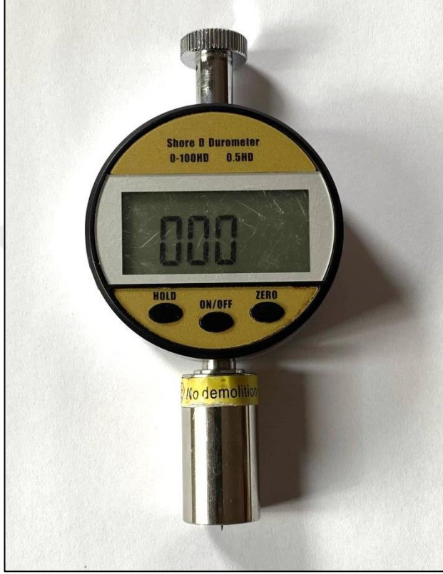
Resim 2.1. Çalışmada kullanılan sertlik ölçer cihazı (Durometre) (Loyka D-tip)
