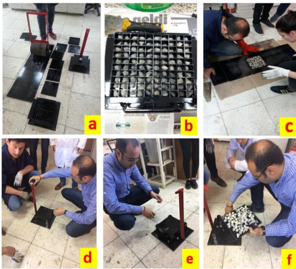
Şekil 3. Vialit deney aşamaları, a) Vialit deney aparatları. b) Agregaya serici. c) Numunenin silindirenmeden önce klavuzlanması. d-e-f) Bilya düşürme aşamaları.
