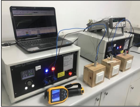
Şekil 20. Aşırı akım testi uygulanan anahtar ürünlerinin test ve ölçüm düzeneği
