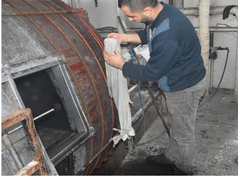
Şekil 97. Yağ Giderme İşlemi ve Sama İşlemi.
