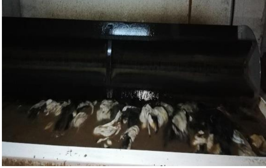
Şekil 89. Yumuşatma İşlemi-Kelebek Makinesinde Islatma.
