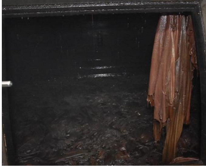
Şekil 105. Derilerin Boyanması ve Yağlanması.
