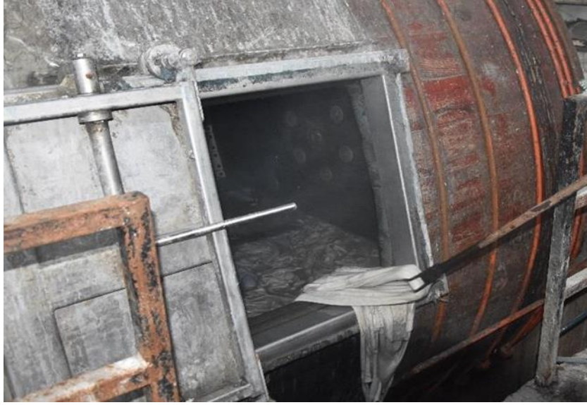
Şekil 95. Kireç Giderme Dolabı ve İşlemi.
