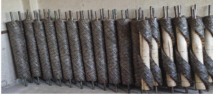
Şekil 120. Çırçır Rölesi Yapım Aşamaları.
