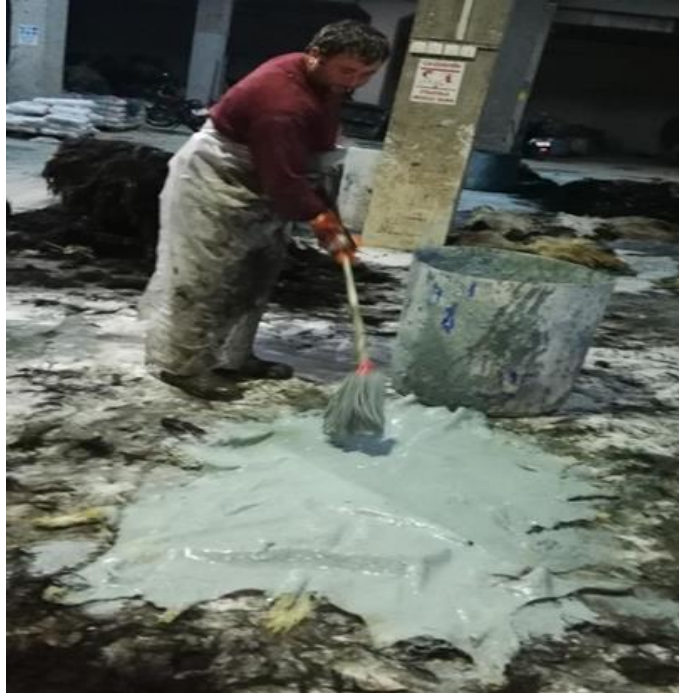
Şekil 90. Zırnıklama- kireçleme İşlemi.
