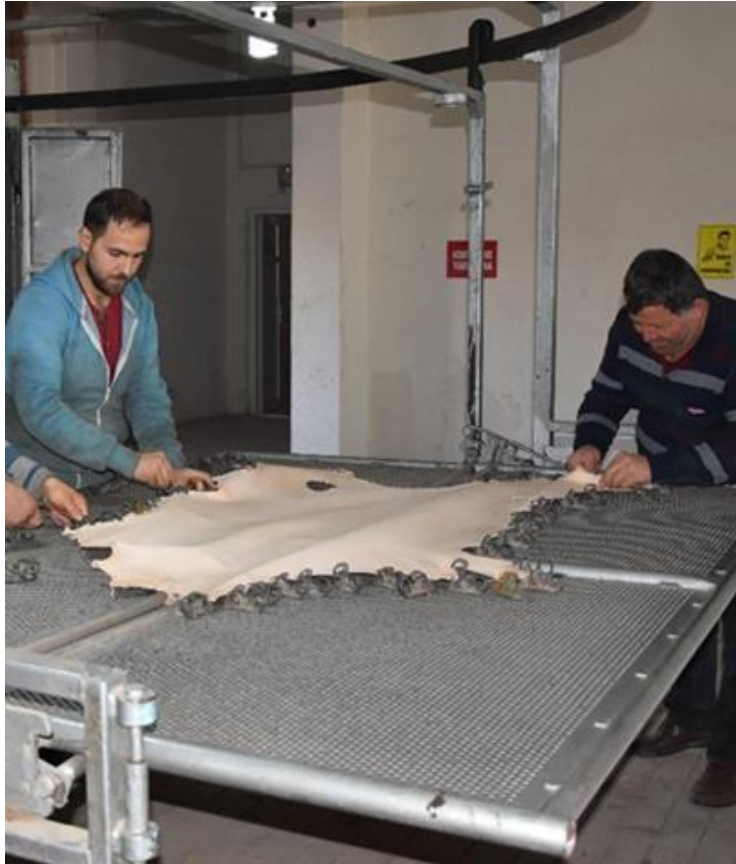
Şekil 110. Derilerde Germe İşlemi.
