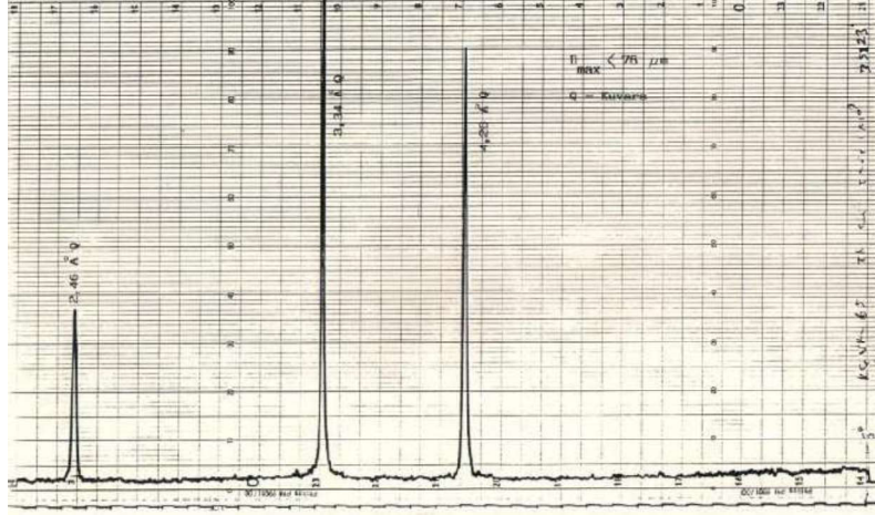
Şekil 9- Alacaagzi Yolundaki 1. Seri Velibey Kumtaşının XRD Yöntemiyle Elde Edilen Tüm Kayaç Difraktogramı ( 2\theta=5-37^\circ ) ve Çözümlemesi.
