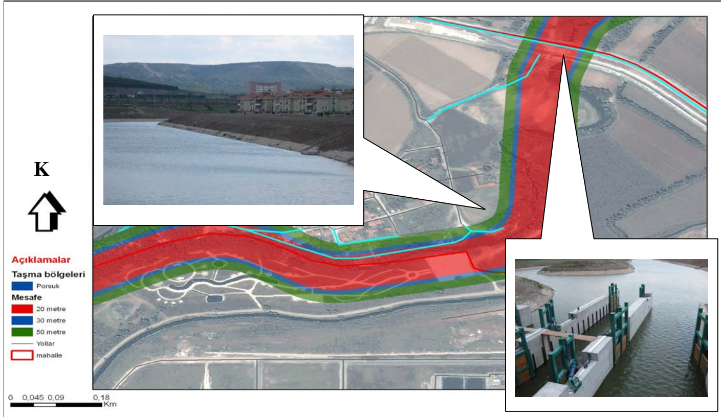
Şekil 5.22. Orhangazi Mahallesi'nde Porsuk Çayı'nın taşkın alanına kurulan Hisarkent Sitesi'nin yerleşim alanlarına yönelik taşkın analizi (Açık renkle gösterilen yollar sular altında kalmaktadır).
