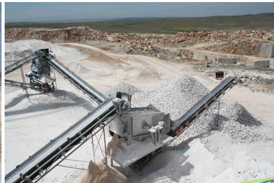
Foto 44-45. Sanayisi tesislerinden çıkan parça mermerlerin yol yapımında kullanılmak üzere mıcır haline getirilip işlendiği tesisten bir görünüm.
