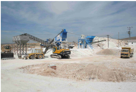
Foto 44-45. Sanayisi tesislerinden çıkan parça mermerlerin yol yapımında kullanılmak üzere mıcır haline getirilip işlendiği tesisten bir görünüm.
