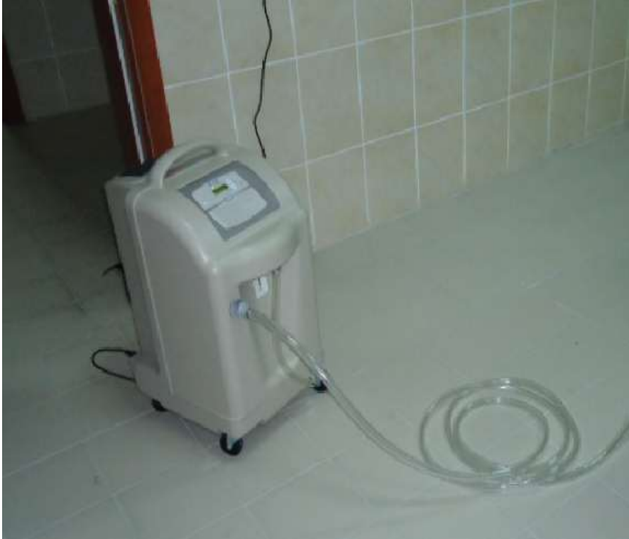
Resim 2. Normobarik Yüksek İrtifa Simülatörü Kompansatörü.
