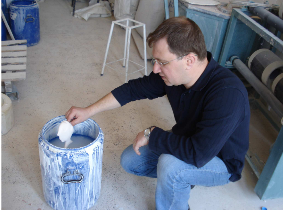
Resim 110: Daldırma yöntemi ile yapılan sırlama.
