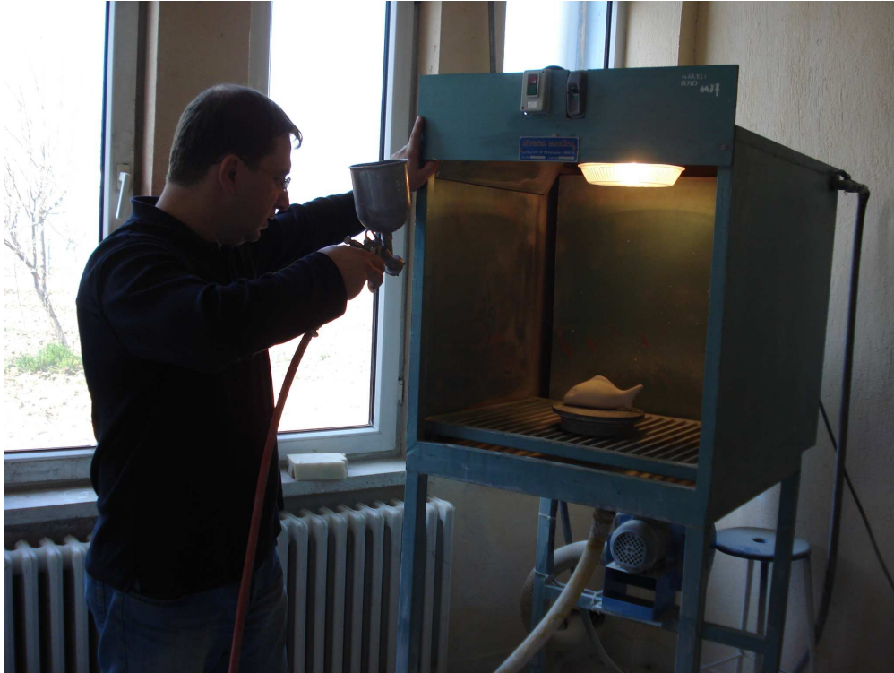
Resim 111: Püskürtme yöntemi ile yapılan sırlama.
