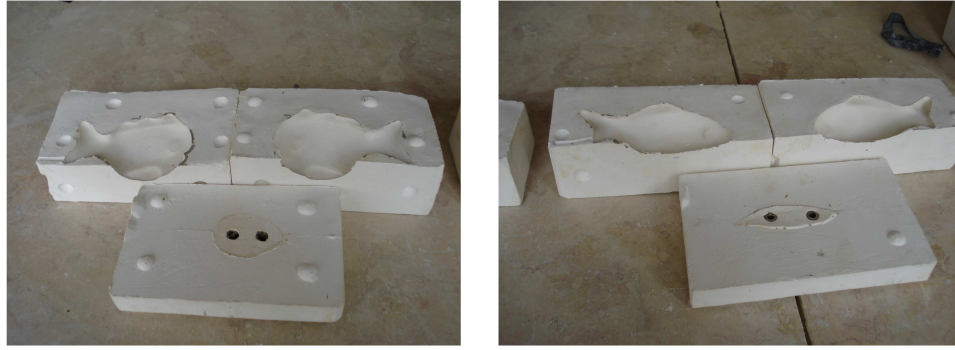
Resim 104: Kalıpların tamamlanmış hallerinden örnekler.
