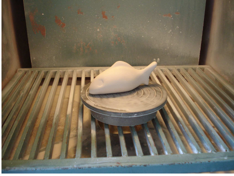
Resim 112: Püskürtme yöntemi ile yapılan sırlama.
