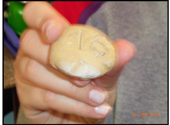
Resim 22 . Afyonkarahisar-Gazlıgöl Kil Örneklerinden Olan 16 Numaralı Kilin Kururken Yüzeyinde Toplanan Soda Kristalleri
