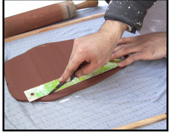
Resim 80-81: amurun merdane ile plaka Őeklinde aılması
