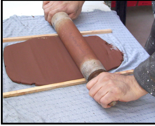
Resim 80-81: amurun merdane ile plaka Őeklinde aılması
