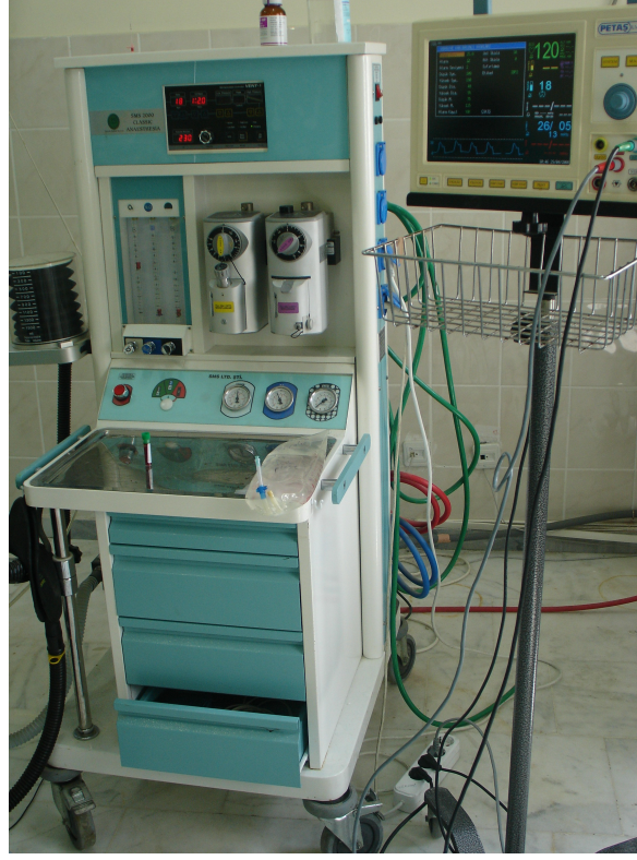
Resim 2-1: İzoflorane anestezisi uygulanan entübe anestezi cihazı
