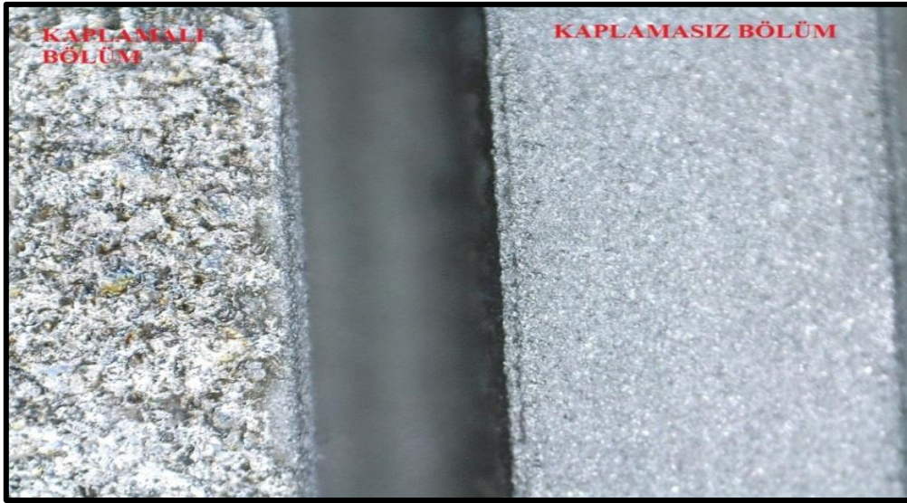
Resim 2.3 Esd Yöntemi ile Pistonun Yüzeyi Ni Kaplaması.
