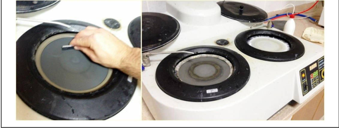
Resim 3.2 İç Yapı Analizi İçin Zımparalama İşlemi Yapılması.
