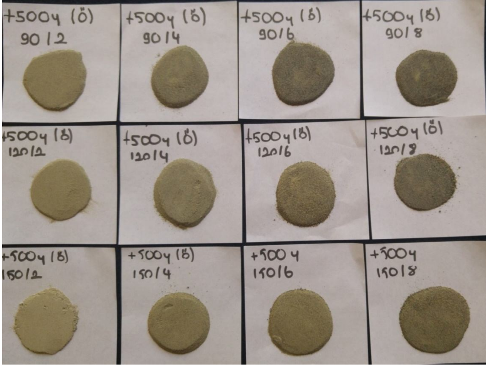
Şekil 4.2 + 500 µ' dan, - 212 µ' a öğütülerek yapılmış KGS deney sonucu görselleri.
