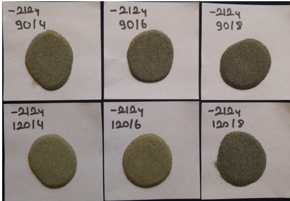
Şekil 4.6 - 212 \mu 90 ve 120 G' de KGS deney sonuçlarının karşılaştırmalı görünümü.
