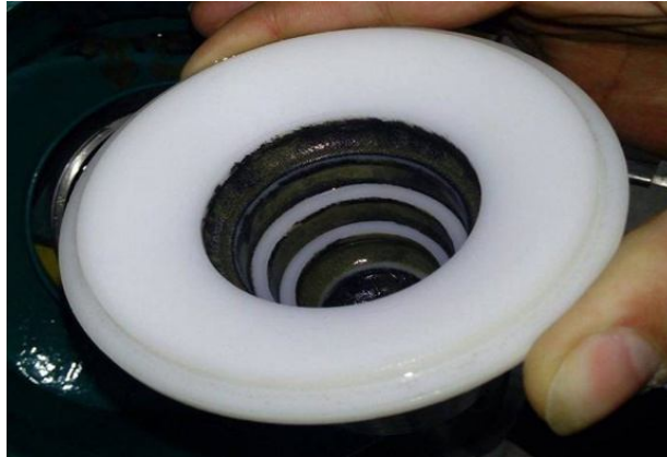
Şekil 4.1 Knelson Gravite Konsantratör çanağında biriken krom görseli.
