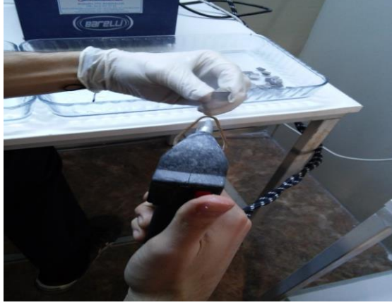
Resim 5.3 Buhar basınçlı tabanca ile Ti6Al4V numunelerin temizlenmesi.
