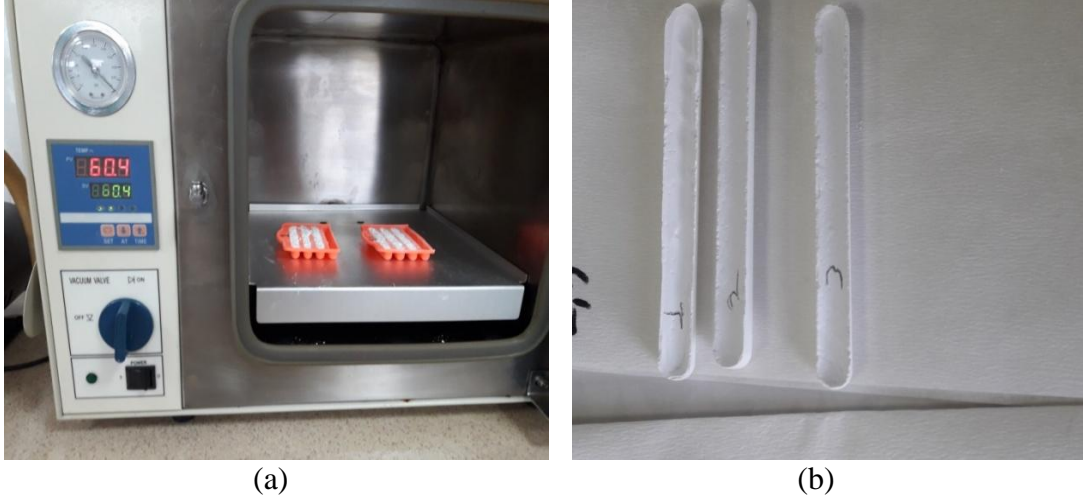
Resim 3.5 (a) Vakumlu etüv, (b) Alümina bünyeler.
