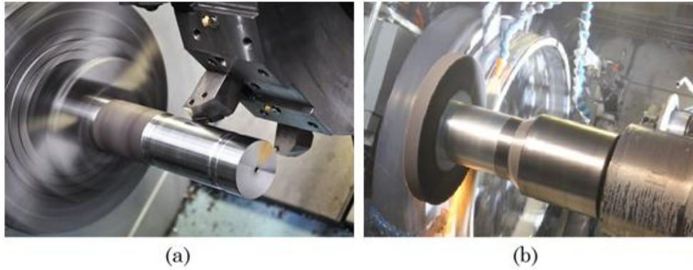
Resim 2.1 Talaşlı imalatta kesme işlemi (a) ve taşlama işlemi (b) (İnt.Kyn.1, İnt.Kyn.2).
