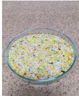
Resim 3.4 D_p < 2 \text{ mm} parçacık boyutlu YYPE numunesi.
