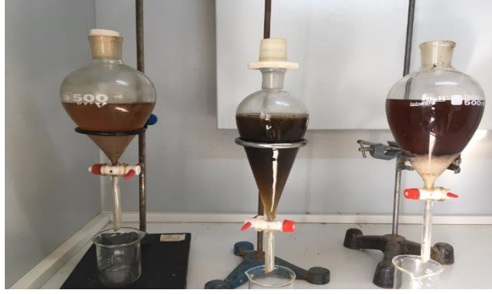
Resim 3.7 Deneý sonucu oluřan sıvı fazların ayırma hunisi ile ayrılması.
