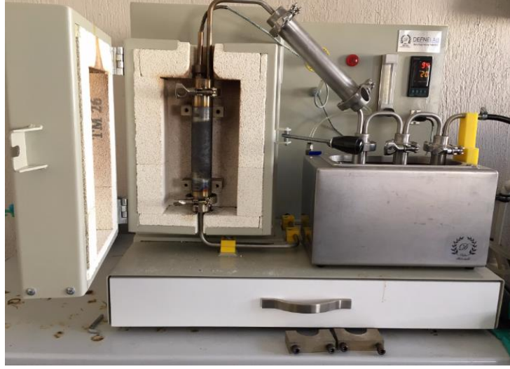
Resim 3.6 Denejde kullanılan piroliz cihazı.
