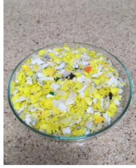
Resim 3.2 6,3 \text{ mm} < D_p parçacık boyutlu YYPE numunesi.
