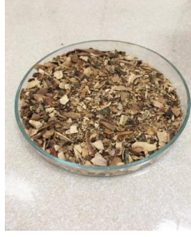
Resim 3.5 D_p < 6,25 mm parçacık boyutlu kabak numunesi.
