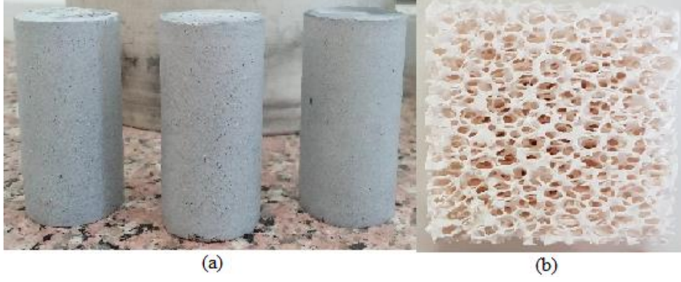
Resim 4.1 Mukavemet testi öncesi numuneler. (a) Rulo deneme numunesi (b) köpük filtre deneme numunesi.
