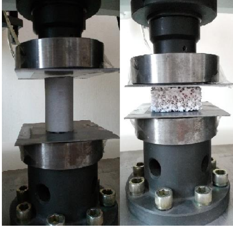
Resim 4.2 Seramik rulo ve seramik köpük filtre mukavemeti testi.
