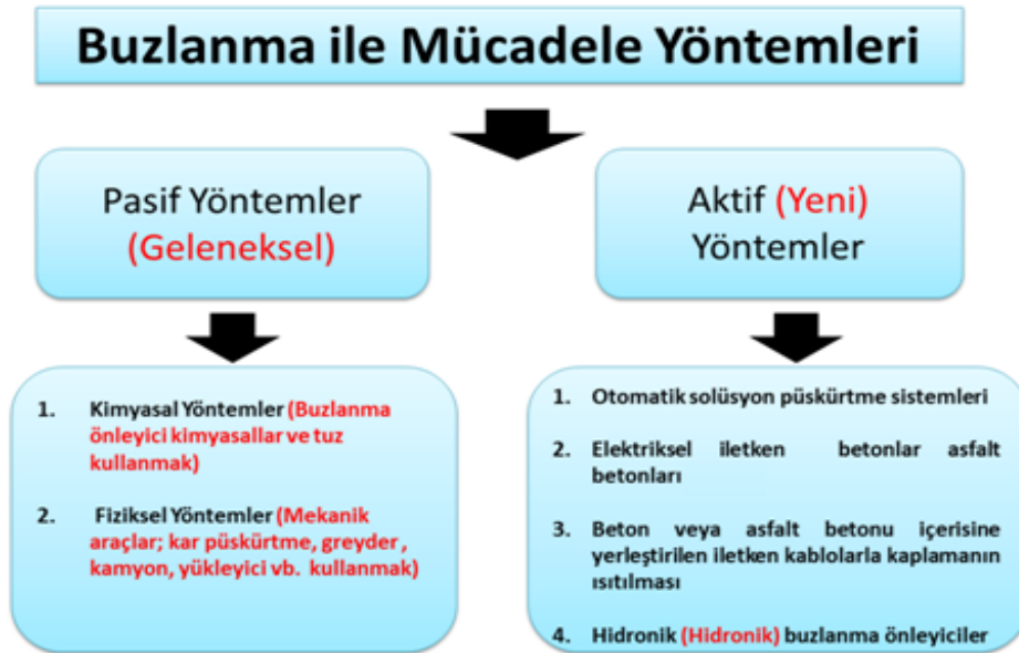
Şekil 2.1 Karayollarında buzlanma ile mücadele yöntemleri (Gürer 2014).
