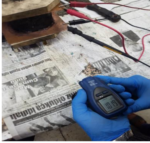
Resim 3.8 İnfrared termometre ile numunelerdeki sıcaklık değişimlerinin ölçülmesi
