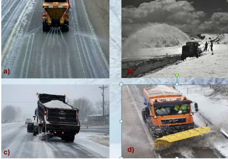
Resim 2.1 Buzlanma ile mücadelede pasif yöntemler, a) Solvent püskürtme aracı b) Rotatif kar üfleme aracı c) Karayolu tuzlama çalışması d) Kar Sıyırıcı (Gürer 2014).
