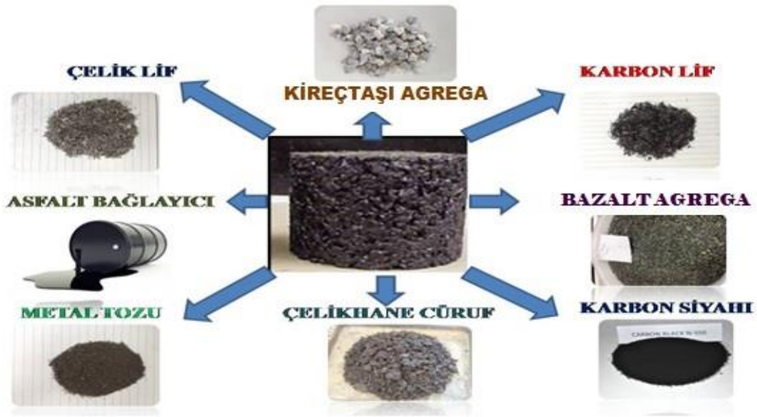
Şekil 3.1 İAB Karışımlarda kullanılan agrega ve iletken bileşenler.
