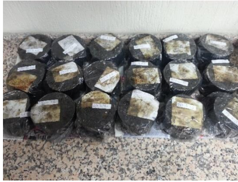
Resim 3.5 Üretilen iletken asfalt betonu numuneleri.
