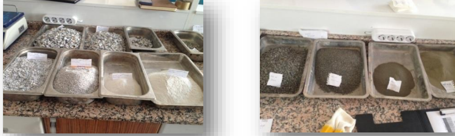
Resim 3.1 Karışım için yıkayıp elenen kireçtaşı ve bazalt agrega numuneleri.
