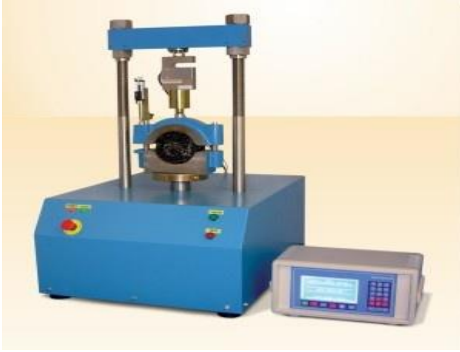
Resim 3.9 Marshall stabilite-akma deney cihazı.
