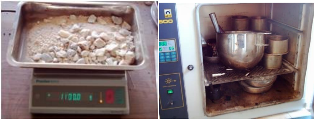
Resim 3.3 Karışımların tartılması, kalıp ve karışımların etüvde ısıtılması.
