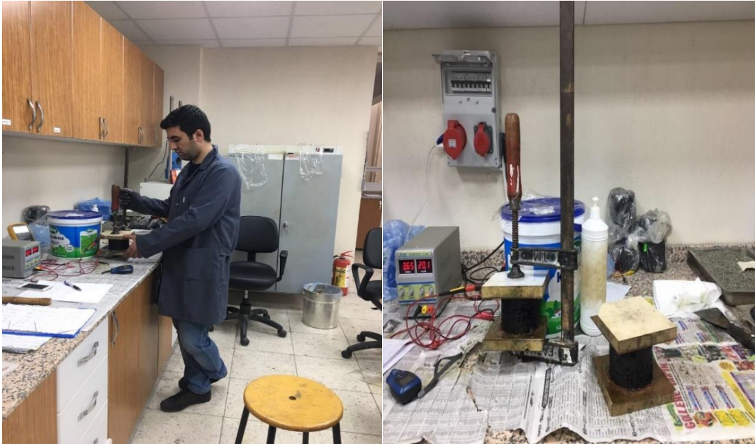
Resim 3.2 Marshall dizaynına göre numunelerin deney hazırlığı.
