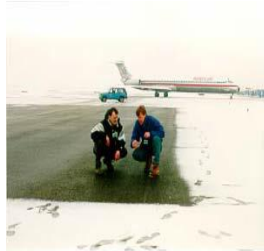
Şekil 2.10 Snowfree® (elektriksel iletken asfalt kaplama sistemi) ve karın eritilmesi (Derwin vd. 2003).
